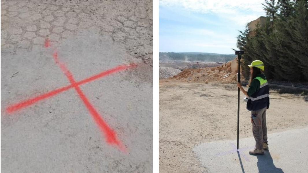
Figura 29: Medição dos pontos de controlo no terreno (a) com recurso à antena móvel (b)
