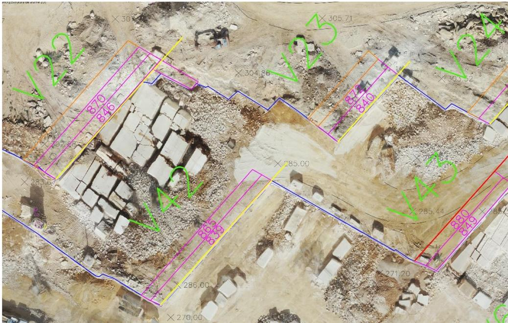
Figura 46: Aproximação da Figura 45 com pormenor do planeamento das frentes de trabalho. Na cor laranja estão representadas as talhadas planeadas para o desmonte do mês de outubro de 2020, a cor-de-rosa as talhadas já derrubadas, com o respetivo número de referência da talhada, e a verde o nome de cada uma das frentes de desmonte.
