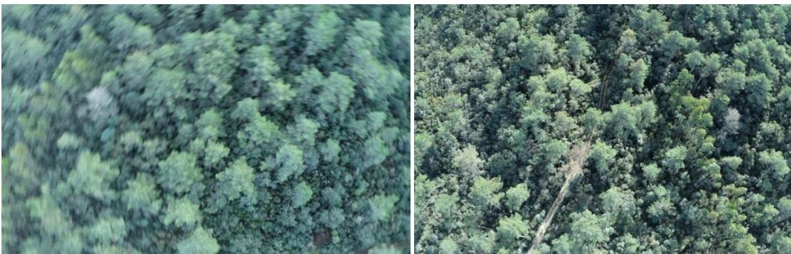
*Figura 53: Exemplo de uma das imagens desfocadas (à esquerda) e de uma das imagens superexpostas (à direita)*
