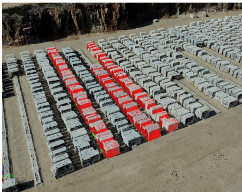
Figura 62: Medição do volume de 101 blocos ornamentais dispostos em filas no parque de blocos
