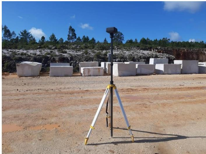
Figura 25: Antena GNSS da marca Dji e modelo D-RTK 2
