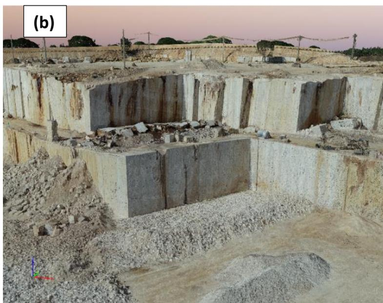
Figura 37: Nuvem de pontos densa: a) imagem geral e b) pormenor de uma bancada
