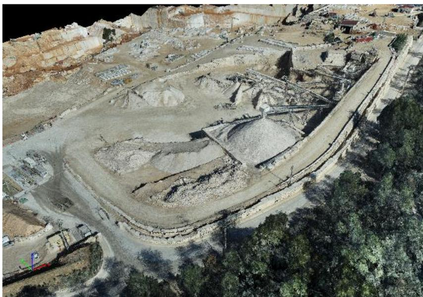
Figura 55: Nuvem de pontos densa do levantamento efetuado na unidade de britagem
