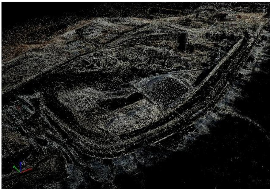
Figura 54: Nuvem de pontos esparsa (pontos de ligação) do levantamento efetuado na unidade de britagem
