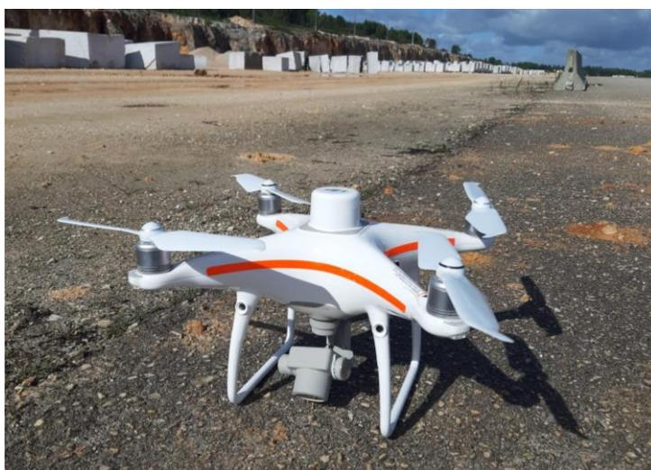
Figura 24: Veículo aéreo não tripulado da marca Dji e modelo Phantom 4 RTK
