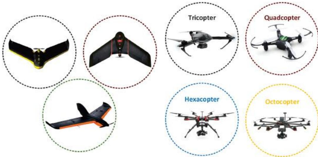
Figura 9: VANTs de asa fixa (à esquerda) e multirotores (à direita) (adaptado de Hu et al, 2019)
